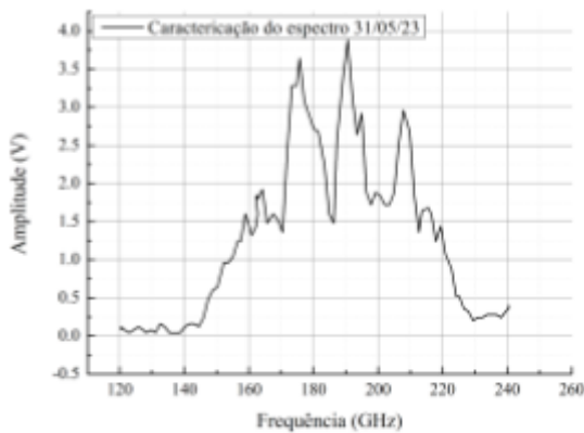
Figura 1 - Caracterização do espectro sub-THz na faixa de frequência entre 120 e 240 GHz, obtida em 31/05/2023
