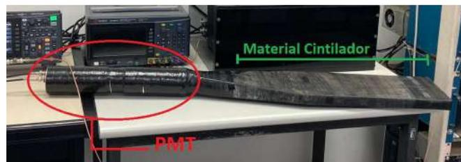
Figura 7: "Raquete" - Tubo fotomultiplicador acoplado a um material cintilador.
