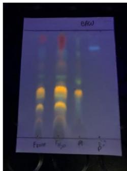
C: Placa BAW, M – morango;  $F_{EtOH}$  – Extrato alcoólico da folha liofilizada;  $F_{H_2O}$  – Extrato aquoso da folha liofilizada antes e após rotaevaporador;  $F_{acetato}$  – Extrato acetato de etila da folha liofilizada, pós NP-PEG. (365 nm)
