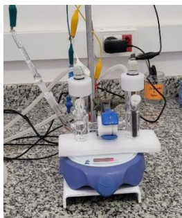
Figura 3: Célula H durante o procedimento de eletrólise
