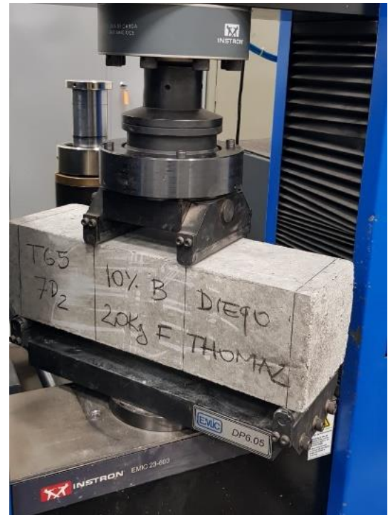
Figura 2: Ensaio de tração na flexão.
