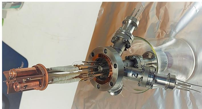
Figura 3: Evaporadora montada
