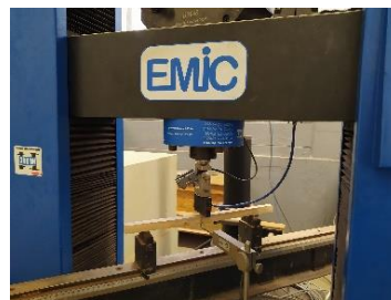
Figura 1. Ensaio de flexão com medições de carga e deformação vertical.
