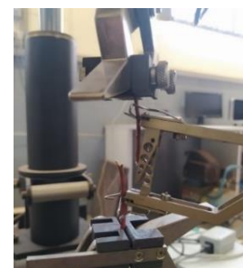
Figura 2. Ensaios nas mudas de eucalipto. Ensaio de ultrassom (a) e ensaio de tração (b).
