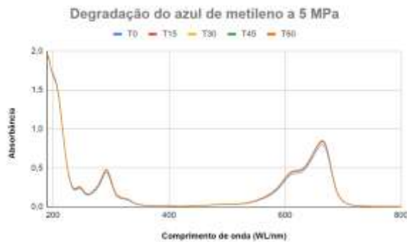
Gráfico 1: Degradação do azul de metileno a 5 MPa
