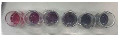
Figura 4: Imagem das soluções empregadas na análise colorimétrica da reação entre nanopartículas e melamina em diferentes concentrações. Da esquerda para a direita: 0 (branco); 1 \mu M; 2 \mu M; 3 \mu M; 4 \mu M e 5 \mu M. Foto registrada 5 minutos após adição.
