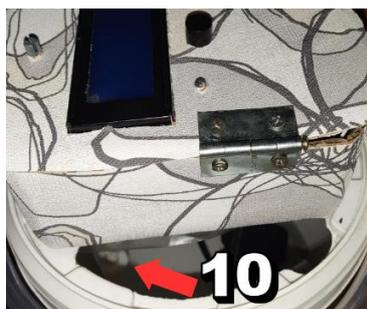
Figura 9: Em 10: sensor de nível tipo bóia
