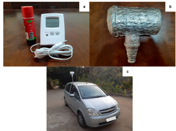
Figura 2 - Termo-higrômetro (a), suporte (b) e veículo equipado para coleta móvel de dados (c)
