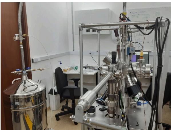
Figura 3: Montagem experimental mostrando o Dewar conectado ao criostato do STM pela transfer line .
