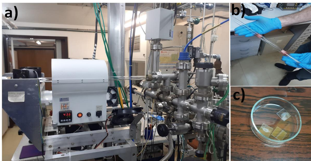
Figura 3 – Tratamento em alta temperatura dos filmes de Cu/Safira(0001). a) Forno de aquecimento tubular à vácuo (e atmosfera de H_2 ) b) Filme de cobre evaporado nas paredes do tubo de quartzo a partir das amostras. c) amostras de safira(0001) parcialmente recoberta com Cu após tratamento térmico.
