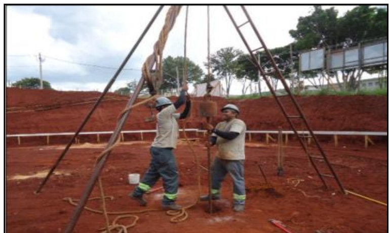
Figura 1 – Exemplo de Sondagem SPT executada na quadra 50 – fonte: https://drive.google.com/drive/folders/19kfP01OMAsQVQlrEIXfwni9HOGxUK-
