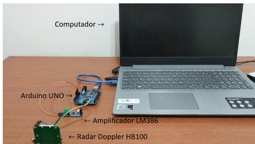
Figura 1: Representação de todo o circuito montado para ler e processar os sinais transmitido pelo módulo HB100
