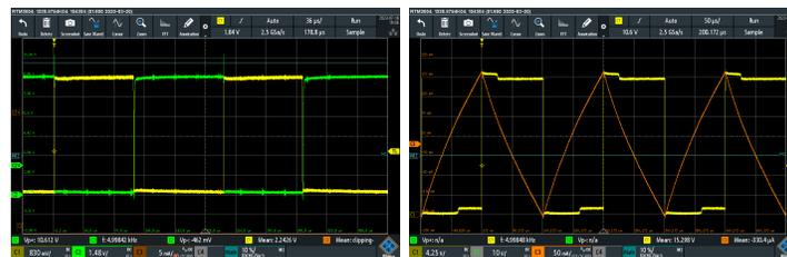
(a) Testes do circuito de acionamento. O sinal em verde é o presente no drain do Mosfet e o sinal em amarelo é o PWM gerado pelo microcontrolador. Nota-se o inversão do sinal
