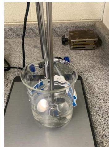
**Figura 1** Preparo de amostra CMC/Laponita no agitador mecânico.
