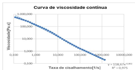
Figura 3 Ensaio de viscosidade sistema 1% CMC e 2% Laponita
