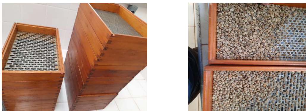
Figuras 1 e 2 - Respectivamente, o jogo de peneiras utilizado para a separação dos grãos de café e os grãos separados entre moca e chato - Fonte: De autoria própria.
