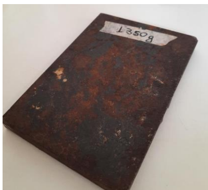
Figuras 6 e 7 - Respectivamente, placa utilizada para proporcionar a força normal sobre os grãos e posicionamento da mesma sobre a amostra - Fonte: De autoria própria.
