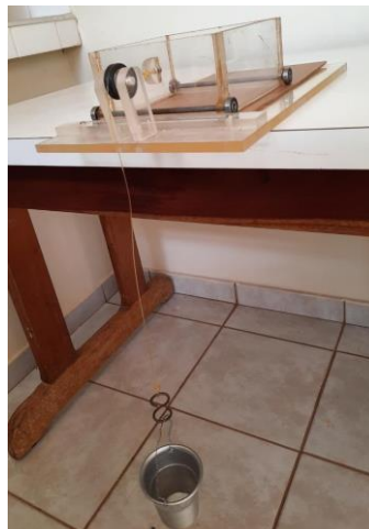
Figura 5 - Passo a passo utilizado para a determinação dos coeficientes de atrito, seguindo com posicionamento do módulo, posicionamento da superfície, preenchimento do compartimento com grãos e adição de contrapeso - Fonte: De autoria própria.
