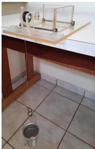
Figura 5 - Passo a passo utilizado para a determinação dos coeficientes de atrito, seguindo com posicionamento do módulo, posicionamento da superfície, preenchimento do compartimento com grãos e adição de contrapeso - Fonte: De autoria própria.
