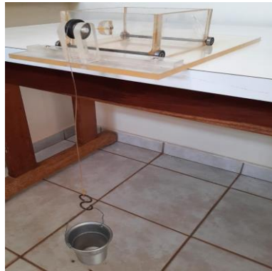
Figuras 3 e 4 - Respectivamente, o módulo de acrílico utilizado para a determinação dos coeficientes de atrito e as superfícies utilizadas, estando ordenadas em aço inox, chapa galvanizada, alumínio e MDF - Fonte: De autoria própria.
