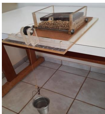
Figuras 6 e 7 - Respectivamente, placa utilizada para proporcionar a força normal sobre os grãos e posicionamento da mesma sobre a amostra - Fonte: De autoria própria.
