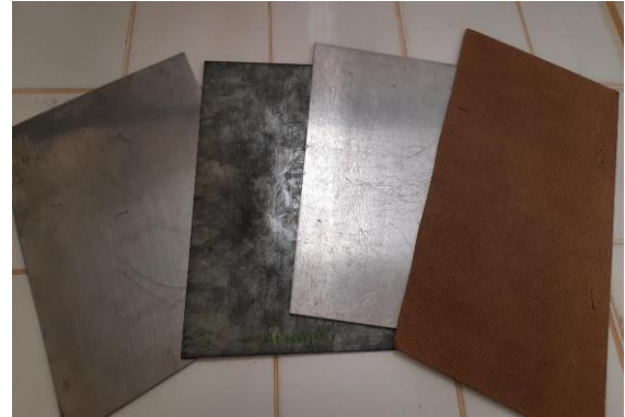
Figuras 3 e 4 - Respectivamente, o módulo de acrílico utilizado para a determinação dos coeficientes de atrito e as superfícies utilizadas, estando ordenadas em aço inox, chapa galvanizada, alumínio e MDF - Fonte: De autoria própria.
