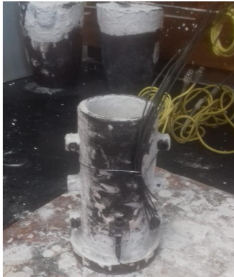
Figura 1 - Lingoteira preparada para o vazamento do metal líquido.
