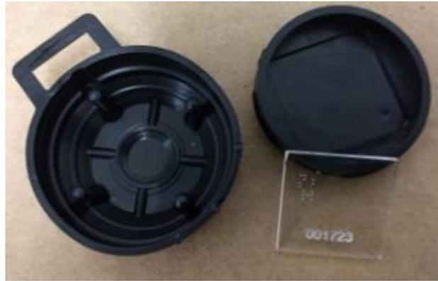
Figura 1: Detector de radônio DTPA modelo CR-39, desmontado apresentando a capa de proteção e o polímero sensível a radiação alfa (transparente) que fica no interior do detector. O polímero se comunica com o ambiente exterior por meio de ranhuras presentes na capa do detector. Imagem adequada de Dias (2017).
