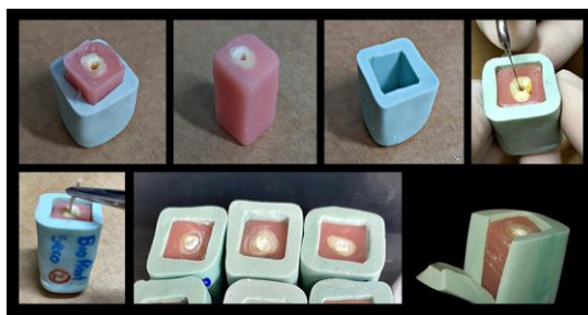
Figura 1. Exemplos das amostras de raiz aderidas ao bloco de resina em moldes de silicone.
