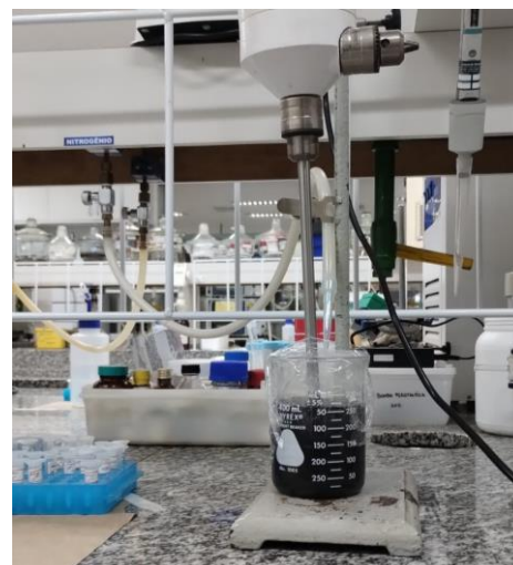
Figura 2: a) Tamanho médio das CoNPs, encontrado com o uso de um Malvern Zetasizer Lab; b) Ilustração do aparato montado para a síntese das nanopartículas. A imagem também ilustra a dispersão formada após a adição do \text{NaBH}_4 .
