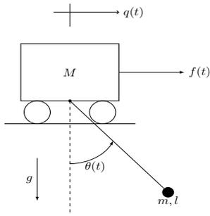
Figura 1: Sistema carro-pêndulo.
