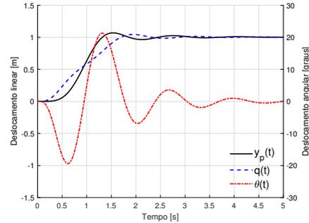
Figura 4:  $y_p$ ,  $q$  e  $\theta$  do sistema em malha fechada local sujeito a uma entrada degrau.
