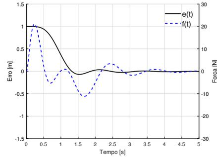
Figura 5:  $e$  e  $f$  do sistema em malha fechada local sujeito a uma entrada degrau.
