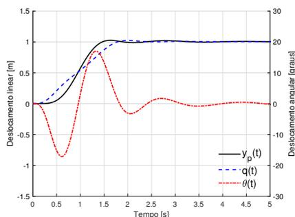
Figura 6:  $y_p$ ,  $q$  e  $\theta$  do sistema em malha fechada global sujeito a uma entrada degrau.
