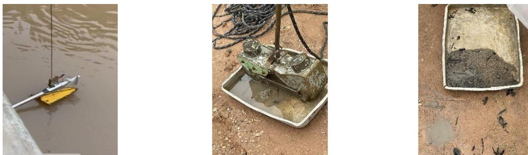
(a) Molinete Fluviométrico (b) Amostrador p/ sedimento do leito Draga tipo Petersen (c) Sedimento coletado
