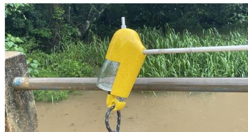
Figura 3 - Amostrador para sedimento em suspensão USDH 48
