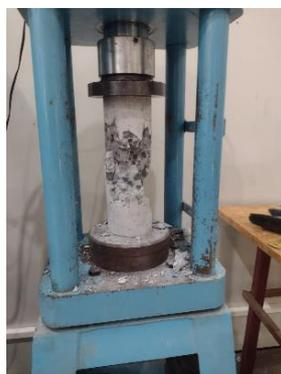
Figura 4: CP de 600°C após ensaio de compressão.
