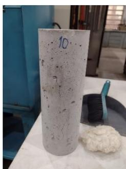
Figura 3: CP exposto a 600°C apresentando fissuras após o aquecimento
