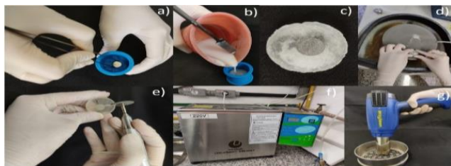
Figura 1- Preparo das amostras. (a) posicionamento dos discos em um porta discos; (b) e (c) inclusão das amostras em resina acrílica; (d) polimento em uma politriz automática; (e) desinclusão; (f) e (g) lavagem e secagem dos espécimes, respectivamente. Fonte: Arquivo da bolsista e do grupo de pesquisa
