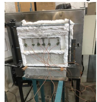
Figura 2 – Adaptação com uma face exposta no forno Mufla
