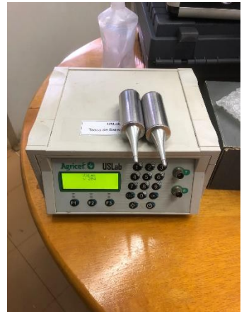
Figura 5 – Aparelho USLab Agricef e Transdutores exponencial 45 KHz
