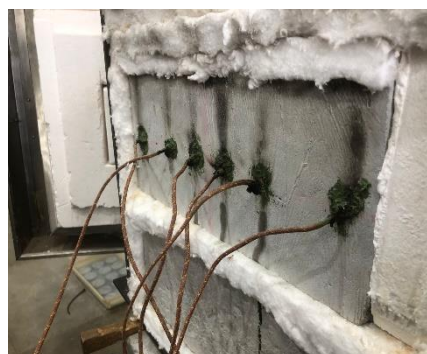
Figura 3 – Posicionamento dos termopares tipo K
