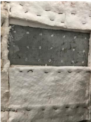
Figura 6 – Malha para medição Indireta do tempo do pulso ultrassônico
