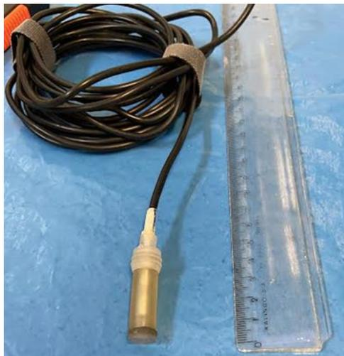
Figura 2- Encaixe do revestimento de silicone à câmera do endoscópio
