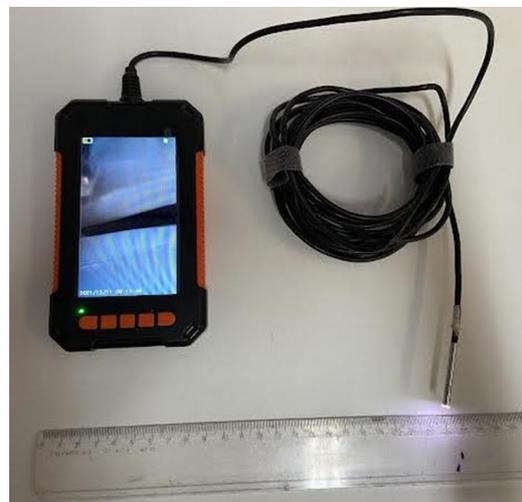
Figura 1 - Endoscópio portátil com LEDs acesos e monitor ligado
