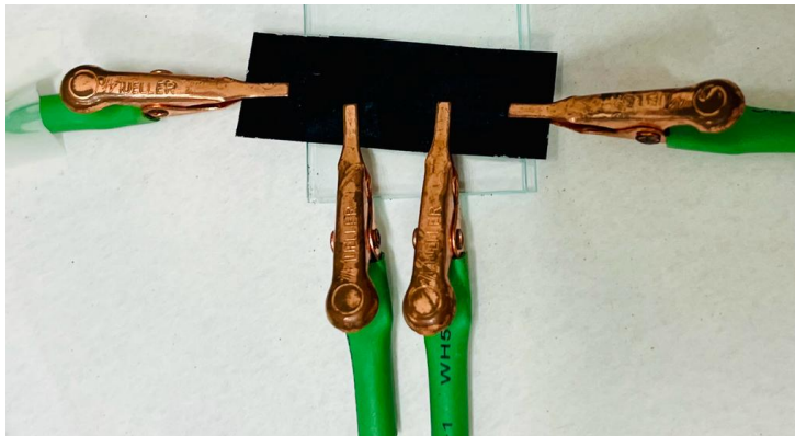
Figura 2 - Representação da posição das quatro pontas na amostra com a amostra na posição 0°
