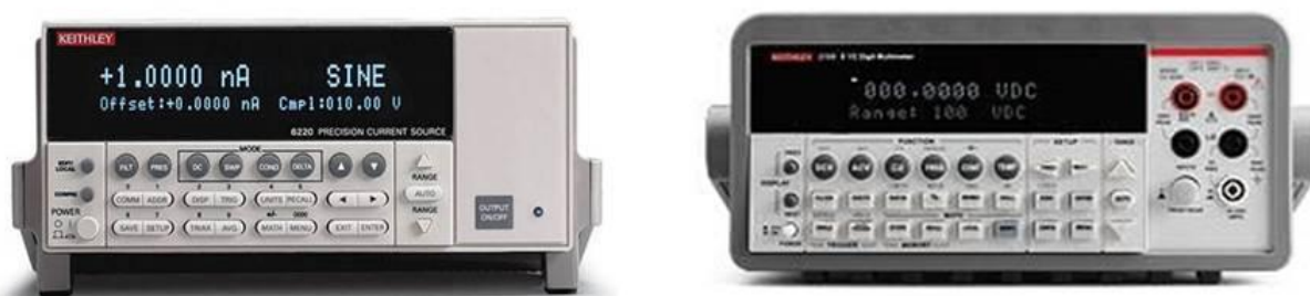
Figura 1 - Fonte de corrente e voltímetro utilizado na medição do sistema de quatro pontas
