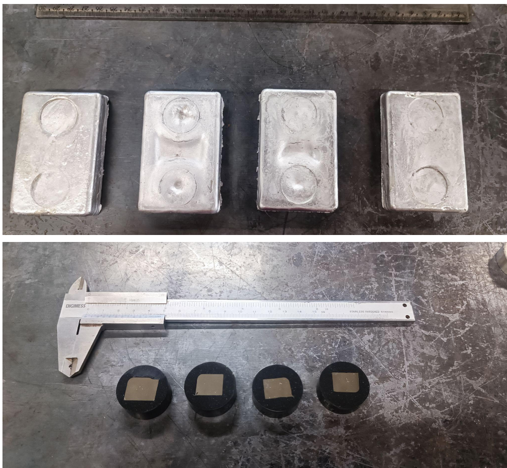
Figura 1 e 2 - Exemplos de peças produzidas e amostras preparadas (Da esquerda para a direita, condição Líquida, 3, 5 e 7 segundos de gás)
