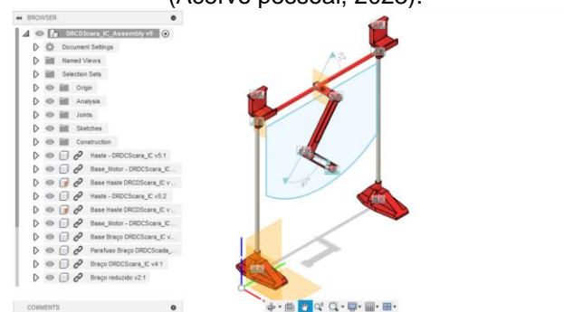
Figura 3 - Projeto do protótipo simples Fusion 360 (Acervo pessoal, 2023).
