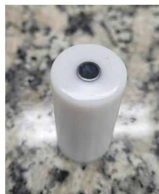
Figura 2 - Suporte condutor de carbono vítreo com ausência da tinta de cobre.
