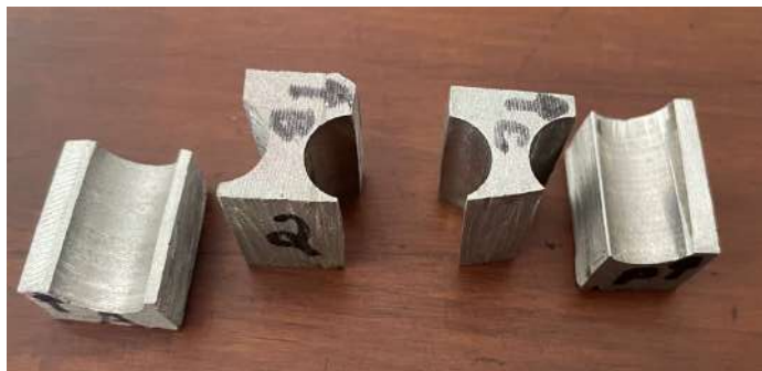
Figura 3 - corpos de prova cortados em seção transversal e longitudinal.
