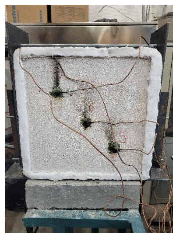
Figura 2- Posicionamento dos termopares na face não exposta
