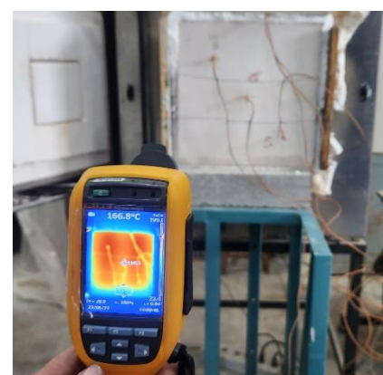
Figura 3- Medição da temperatura com a câmera termográfica
