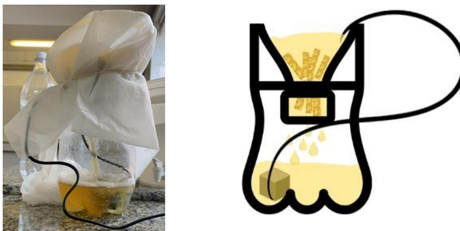
**Figura 1.** Foto e esquema simplificado vinagreira auto aerada.
