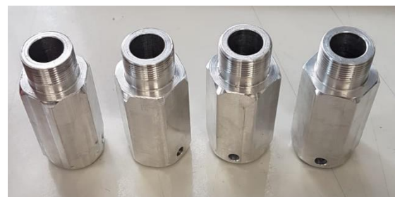
Figura 4 - Espaçadores para a bitola traseira
