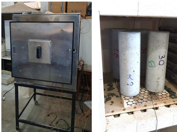
Figura 4 - Forno Mufla (à esquerda) e a disposição dos CP's dentro do forno (à direita)
