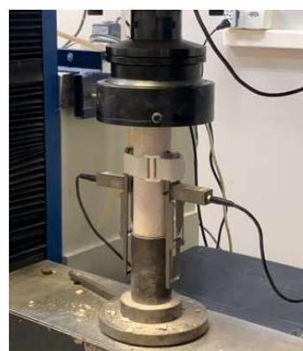
Figura 2 – Ensaio de resistência mecânica e módulo de elasticidade estático – fonte: autores
