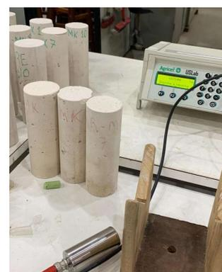
Figura 1 – Equipamento USLab para determinação do Ed – fonte: autores
