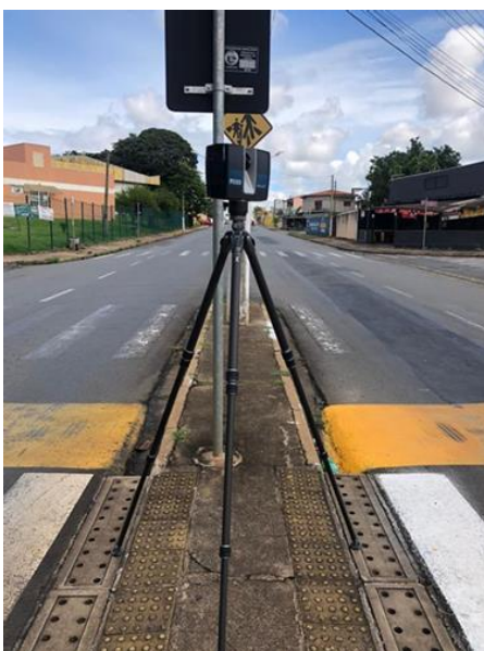
Imagem 3: Laser Scanner 3D modelo FARO Focus M 070. Fonte: Autoria própria (2023)
