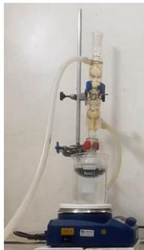
O esquema de refluxo é demonstrado na figura ao lado, sendo a solução mantida em refluxo por quatro dias a uma temperatura em torno de 90°C que após esse período, evaporou-se o solvente, deixando o balão aberto por alguns minutos dentro da capela e a solução foi colocada em um reator e levada a uma estufa a vácuo com temperatura de 100°C por um período de três horas e deixado aberto por algumas horas para secagem.
