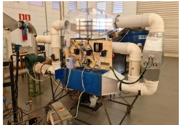
Figura 1: Secador com bomba de calor com configuração parcialmente fechada, depois da adaptação.
