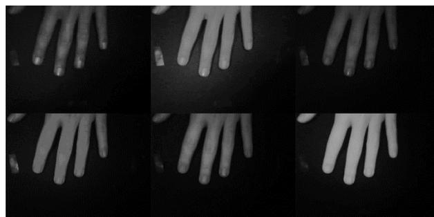
Figura 4: imagens de intensidade relativa da mão em diferentes comprimentos de onda. Estas compõem o *datacube* a ser analisado.
