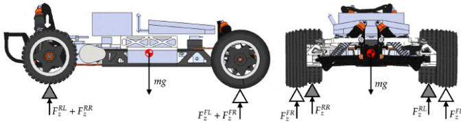
Figura 1: Diagrama de corpo livre do veículo.
