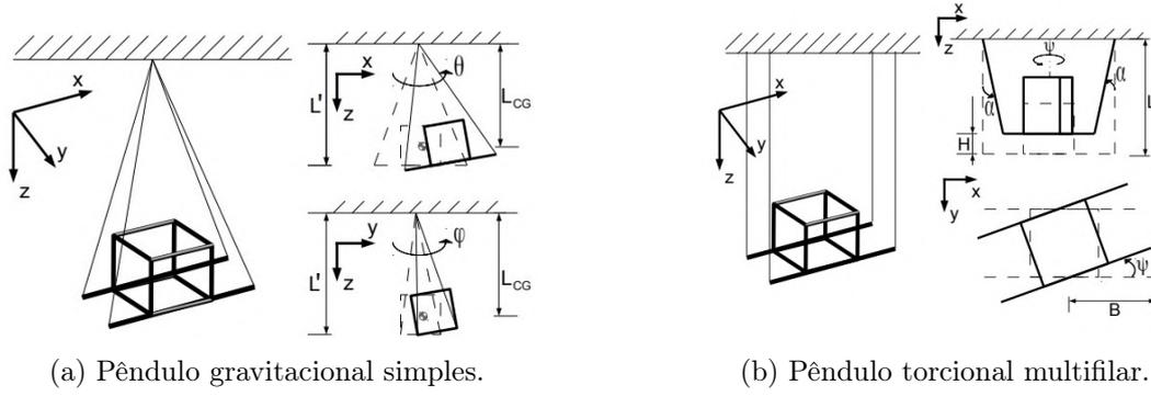
Figura 4: Diagramas dos experimentos de pêndulos, retirados de (Cordeiro et al., 2014).
