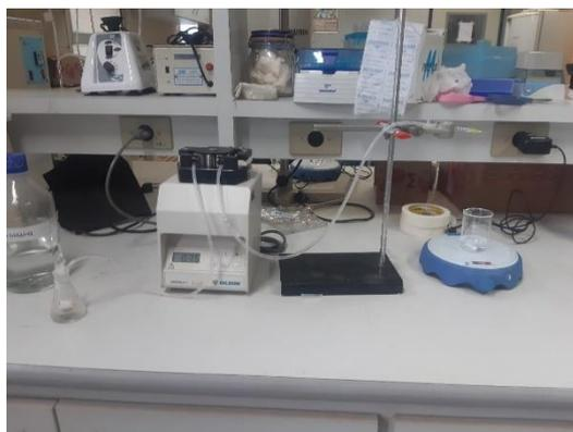
Figura 1: Montagem do sistema experimental utilizado para a produção das partículas.
