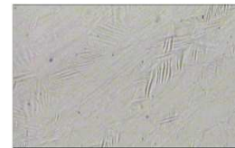
Figura 4. Formação da fase martensítica no composto Ni_{50}Mn_{37}Sn_{13} , caracterizada pelo aparecimento das ranhuras.
