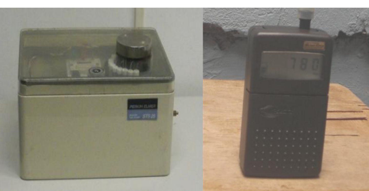
Figura 1: Equipamentos de amostragem interna (Perkin Elmer STS25) e externa (bomba de sucção SKC 210).
