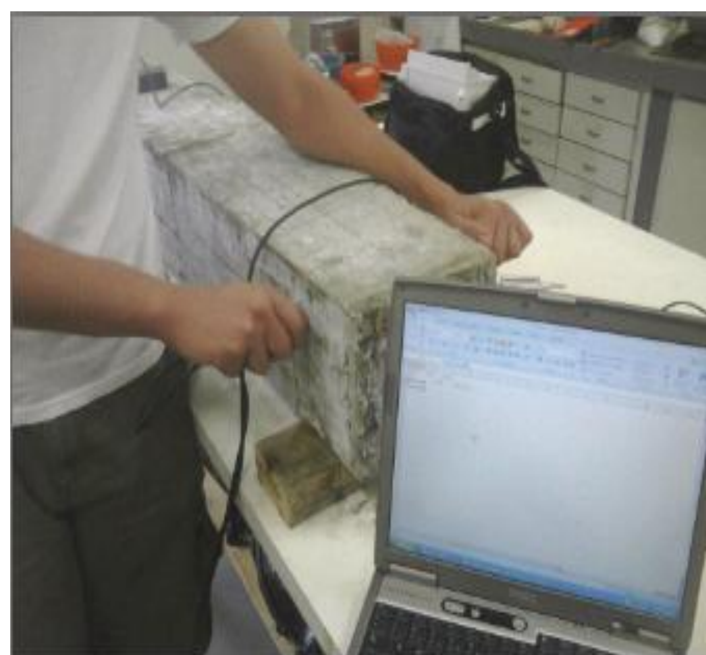
Figura 3: Posicionamento dos transdutores durante o ensaio de Ultrassom na malha XY (faces da peça)
