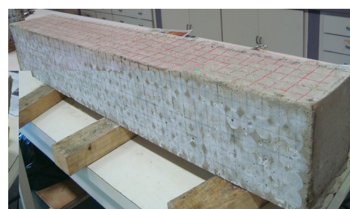
Figura 2 - Malha de medição
