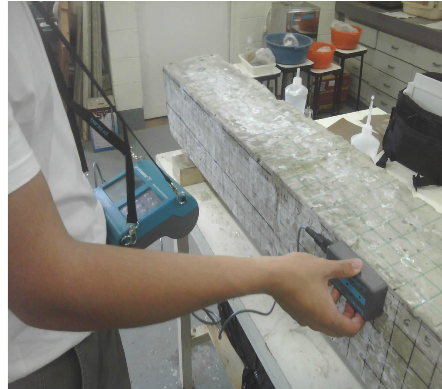
Figura 4 - Ensaio com o detector de barras PROFOMETER5+.
