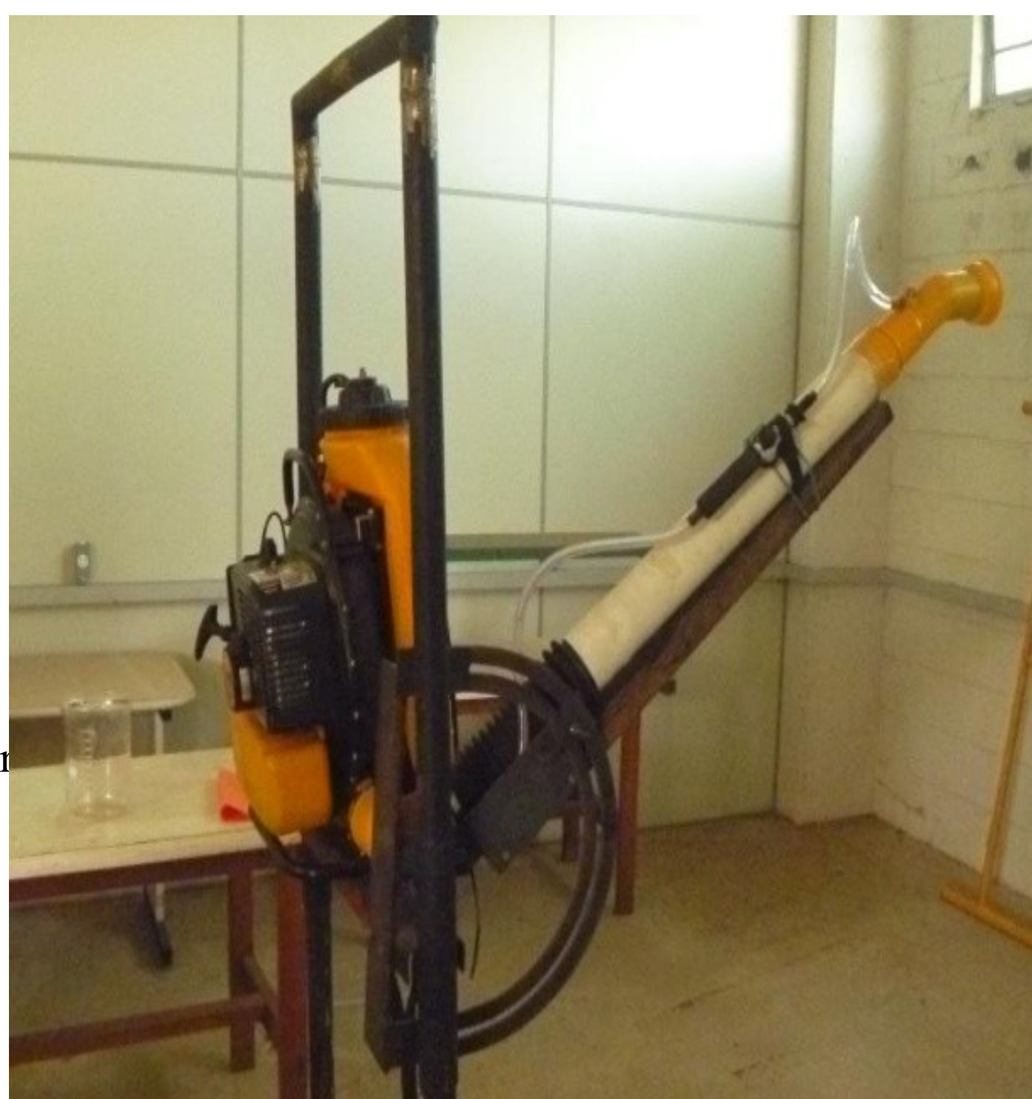
Figura 1: Estrutura para fixar o atomizador costal motorizado.
