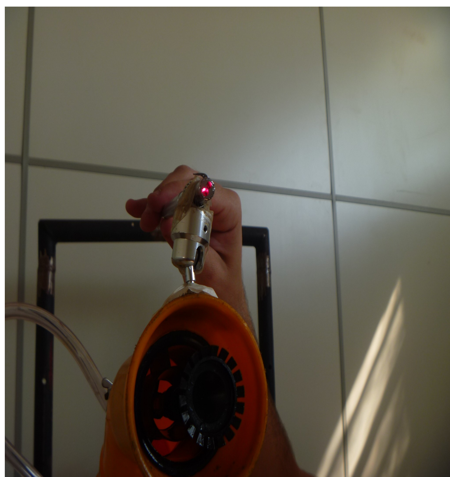
Figura 2: Rótula utilizada como estrutura de fixação da mira laser.
