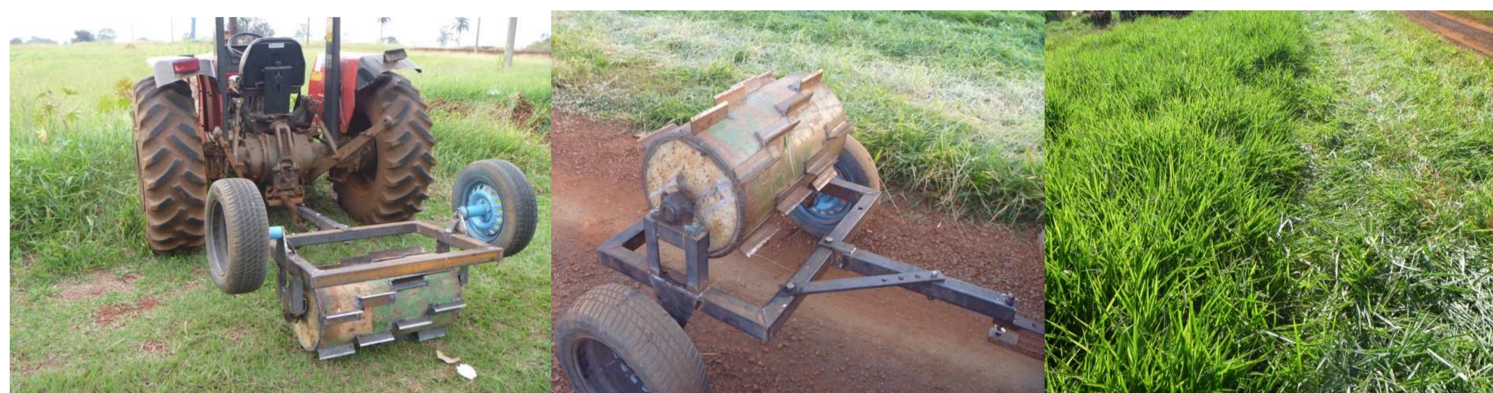
Figura 3: Máquina rolo faca, modo trabalho, modo transportador e área trabalhada
