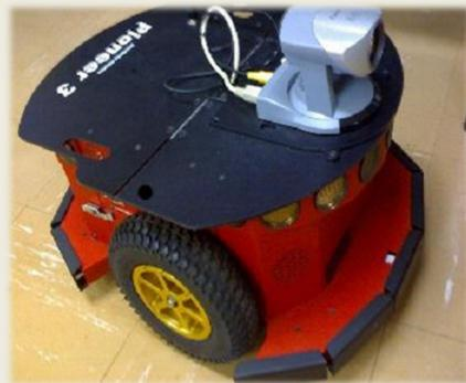
Figura 1: Robô Pioneer P3DX, utilizado nos experimentos.
